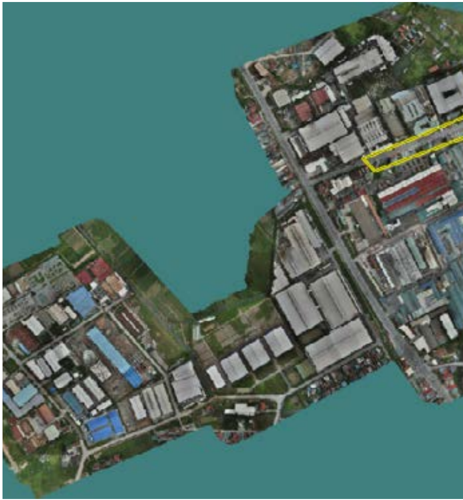
Ảnh trực giao khu công nghiệp được thu nhận từ máy bay UAV DJI Matrice M300 RTK sau khi xử lý bằng phần mềm chuyên dụng
